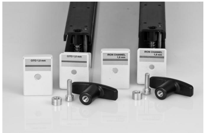
*Nota: Las herramientas para las máquinas GPM 450 SPEED a AirSpeed 450 son idénticas. Debido a la mayor anchura de la máquina AirSpeed 450 es necesario montar un pequeño adaptador de chapa en la herramienta correspondiente que también se guarda en el cajón de residuos - véase la foto.*
