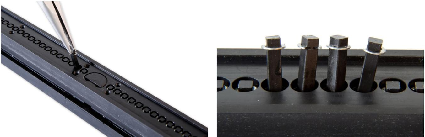
*Nota: Por razones tecnológicas hay dos tipos de punzones en cada herramienta que difieren en longitud (aproximadamente 0,5 mm). Al extraer cada uno de los punzones es necesario marcar en qué orificio el punzón concreto estaba colocado, y devolverlo a su sitio una vez finalizado el trabajo. EL COLOCAR UN PUNZÓN EN UN ORIFICIO ERRÓNEO PUEDE EMPEORAR EL PASO DEL PUNZÓN POR EL PAPEL.*
